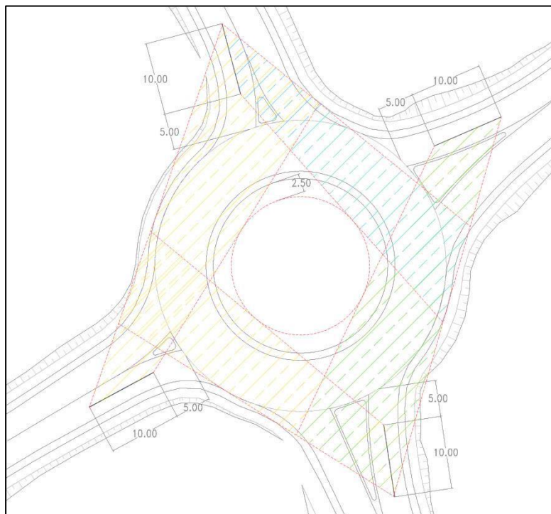
Figura 23 -- Rotatoria SV02_RT01 – Verifica di visibilità a sinistra.
