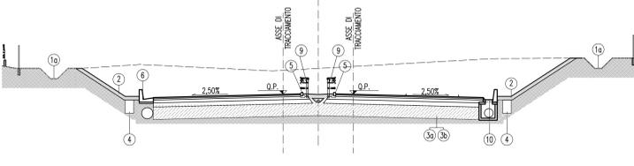
SEZIONE STRADA PRINCIPALE IN RILEVATO IN RETTIFILLO CON PACCHETTO GEODRENO
