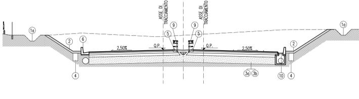
SEZIONE STRADA PRINCIPALE IN RILEVATO IN RETTIFILLO CON PACCHETTO GEODRENO
