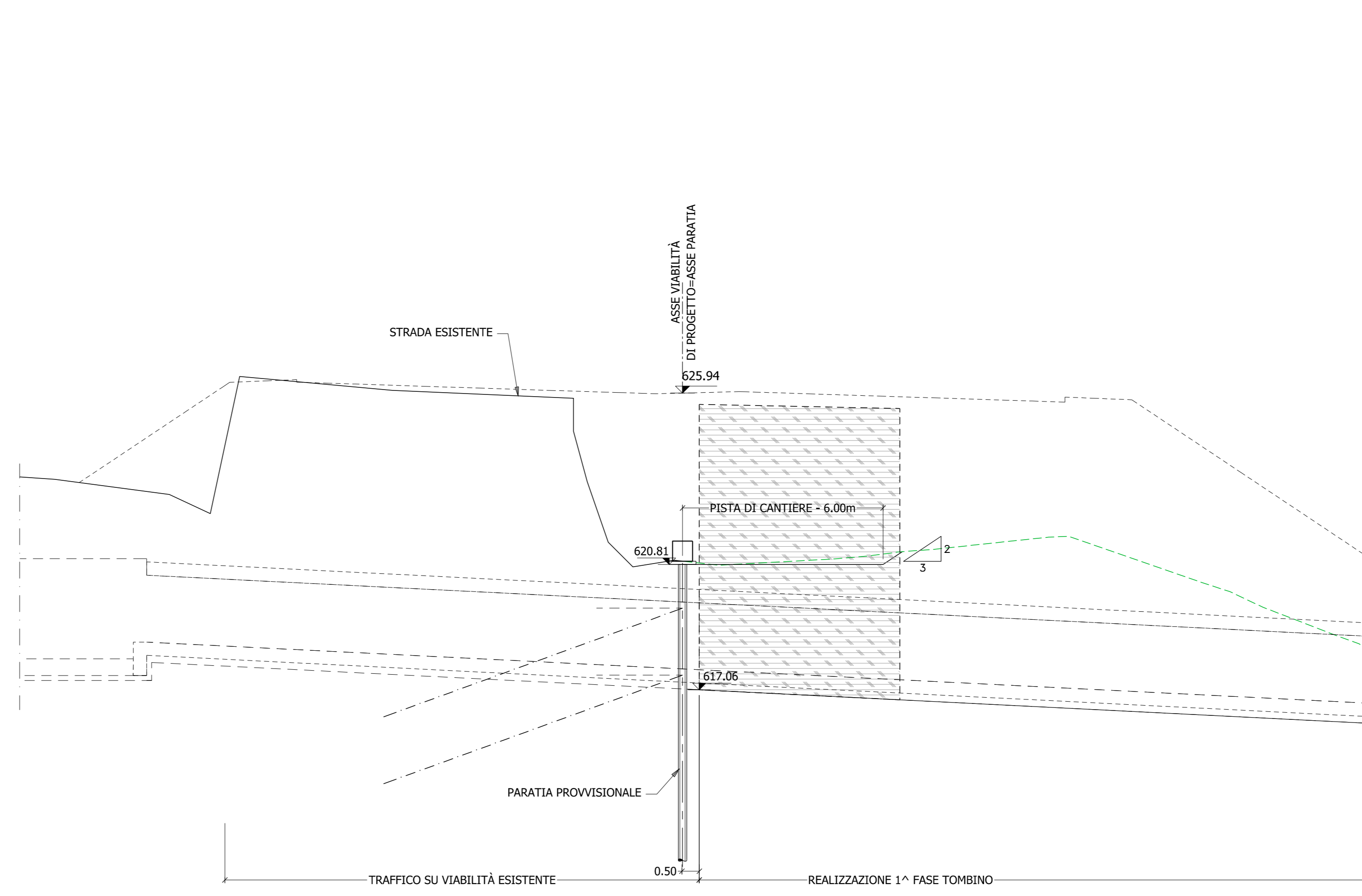
PARATIA DI MICROPALI SEZIONE LONGITUDINALE scala 1:100
