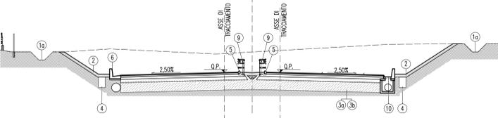
SEZIONE STRADA PRINCIPALE IN RILEVATO IN RETTIFILLO CON PACCHETTO GEODRENO
