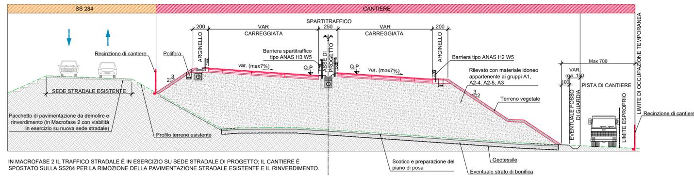
IN MACROFASE 2 IL TRAFFICO STRADALE È IN ESERCIZIO SU SEDE STRADALE DI PROGETTO; IL CANTIERE È SPOSTATO SULLA SS284 PER LA RIMOZIONE DELLA PAVIMENTAZIONE STRADALE ESISTENTE E IL RINVERDIMENTO.
