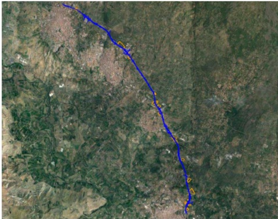
Fig. 23 ortofoto con indicazione del tracciato di progetto e delle aree in cui si riscontra la presenza di terrazzamenti con muretti a secco
