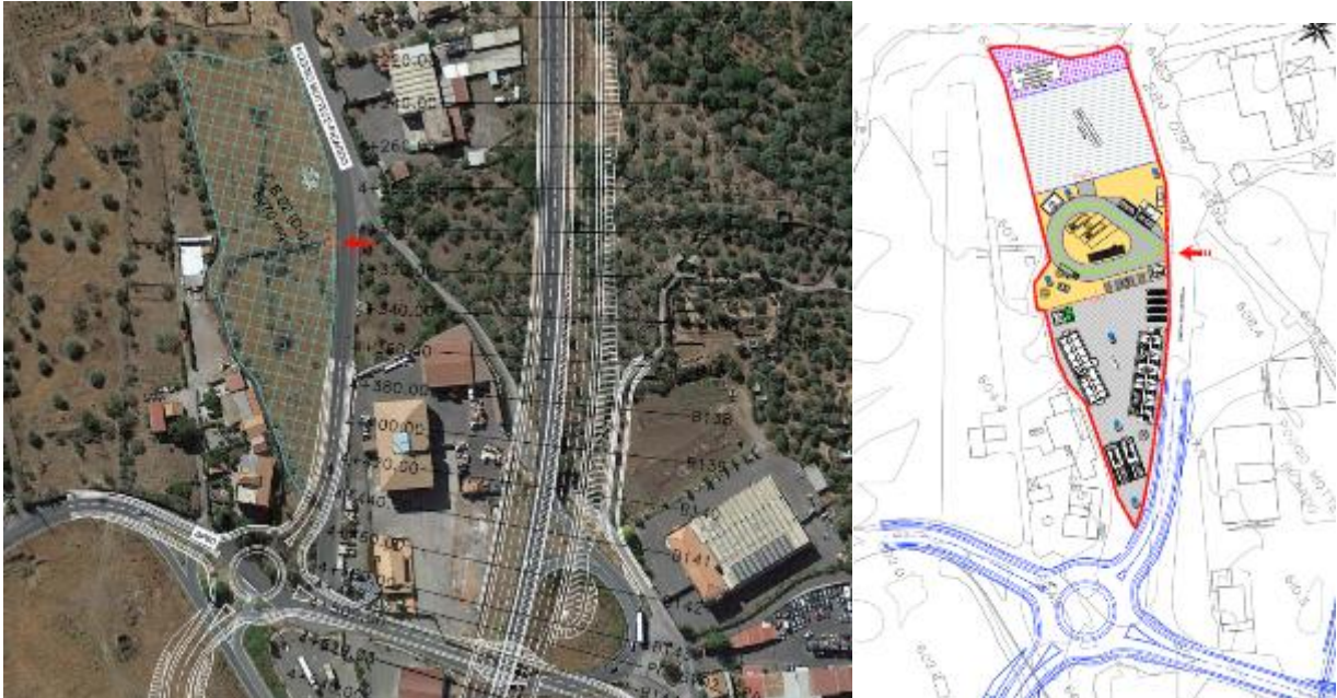
Figura 5-18 - Vista aerea del CB e layout del cantiere
