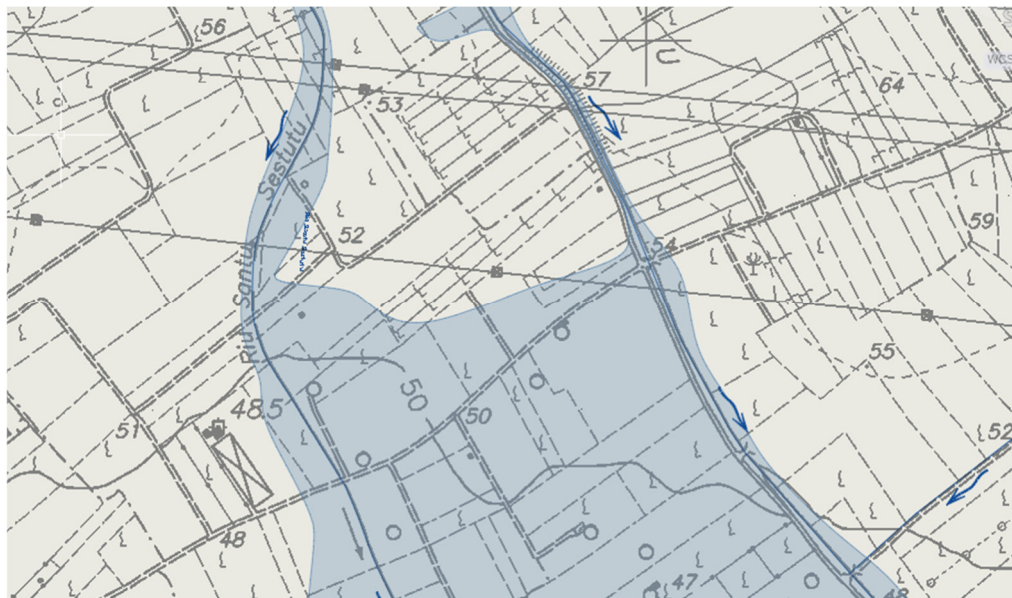
Figura 1.9 - Situazione Ante Operam, allagamenti a monte della viabilità esistente
