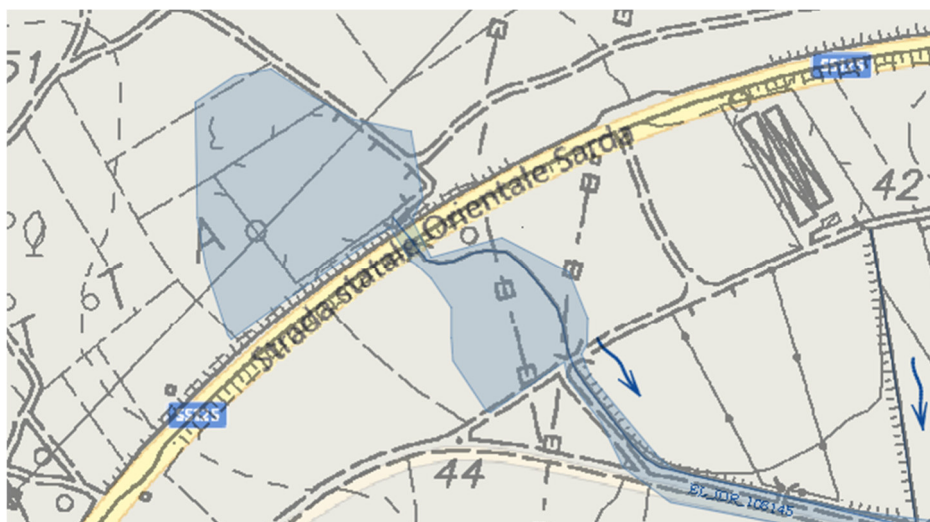
Figura 1.3 - Situazione Ante Operam, allagamenti a monte della viabilità esistente
