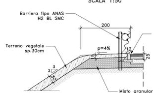
DETTAGLIO MARGINE IN RILEVATO (2)
