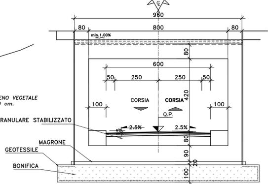
DETTAGLIO PAVIMENTAZIONE SOTTOVIA
