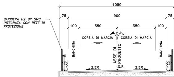
DETTAGLIO MARGINE IN RILEVATO
