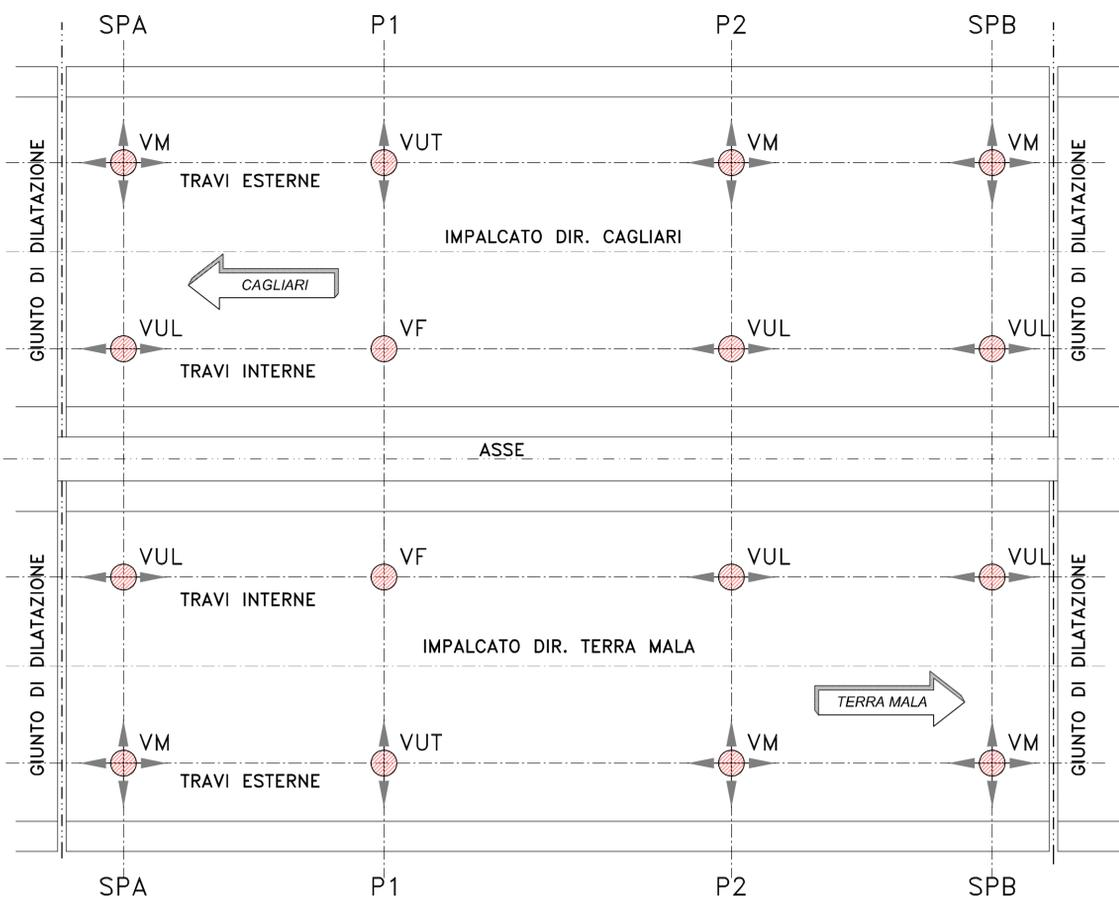
**APPARECCHI DI APPOGGIO IN ACCIAIO-TEFLON A DISCO ELASTOMERICO CONFINATO**
