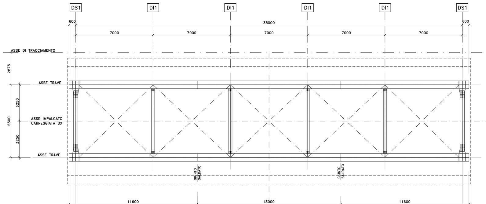
LE CARPENTERIE DEGLI IMPALCATI DELLE DUE CARREGGIATE HANNO LE MEDESIME CARATTERISTICHE. E' RAPPRESENTATO L'IMPALCATO IN CARREGGIATA DESTRA.
