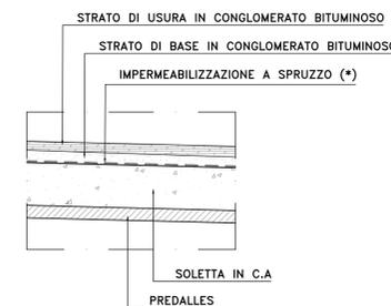
(\*) Impermeabilizzazione a spruzzo eseguita con prodotto elastomerico poliuretano bicomponente. Il rivestimento dovrà essere continuo e perfettamente impermeabile all'acqua, ma permeabile ai gas ed ai vapori acq. Spessore finito non inferiore a 3 mm.
