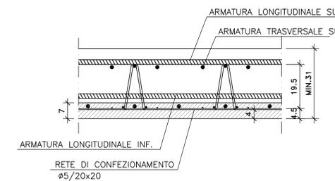
**DETTAGLIO TIPOLOGICO APPOGGIO PREDALLE IMPALCATO A 3 travi B=15.00m**
