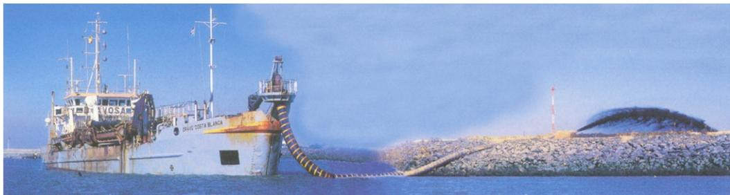
**Figura 10. Draga di aspirazione in funzione di spinta nel recinto**
