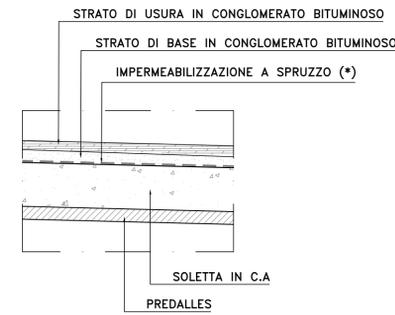
(\*) Impermeabilizzazione a spruzzo eseguita con prodotto elastomerico poliuretano bicomponente. Il rivestimento dovrà essere continuo e perfettamente impermeabile all'acqua, ma permeabile al gas ed ai vapori acq. Spessore finito non inferiore a 3 mm.
