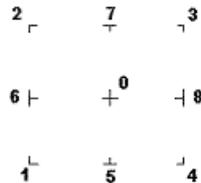
Il codice zero, che è inizialmente associato al centro pilastro, permette anche degli scostamenti imposti esplicitamente del filo fisso dal centro del pilastro
