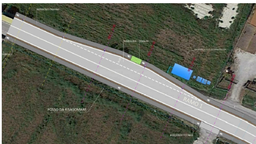
Figura 8: Dettaglio di una area di fermata del trasporto pubblico locale (Fonte: Allegati alla Lista di controllo)
