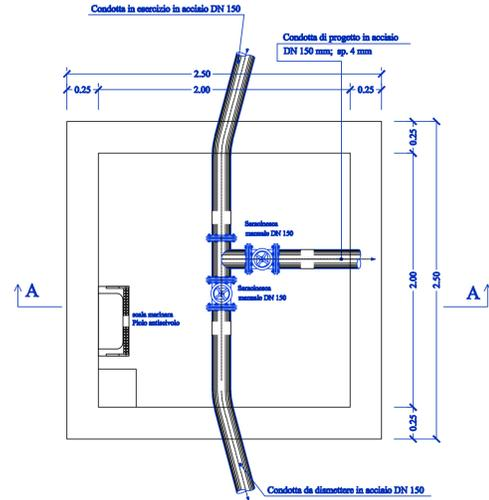
**POZZETTO N°2 ESISTENTE - allaccio alla condotta esistente**
