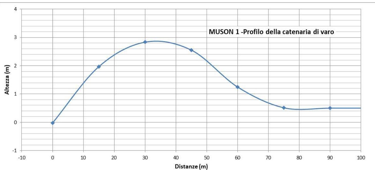
Figura 14 – Calcolo e grafico della curva di varo per angolo di uscita 12°, raggio 200 m. Altezza max. = 2.87 m
