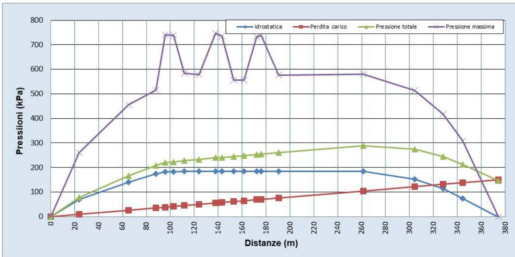
Figura 13- Andamento della pressione operativa e della resistenza del terreno in funzione della distanza dall'entrata
