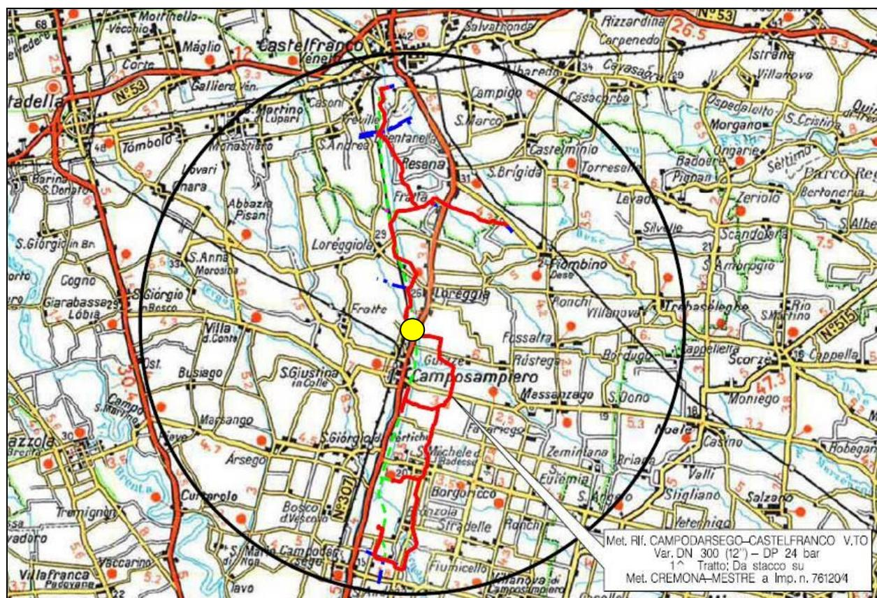
Figura 1– Stralcio Atlante 1:200.000 con localizzazione dell'attraversamento in oggetto (cerchio giallo) lungo il tracciato del metanodotto (in rosso)
