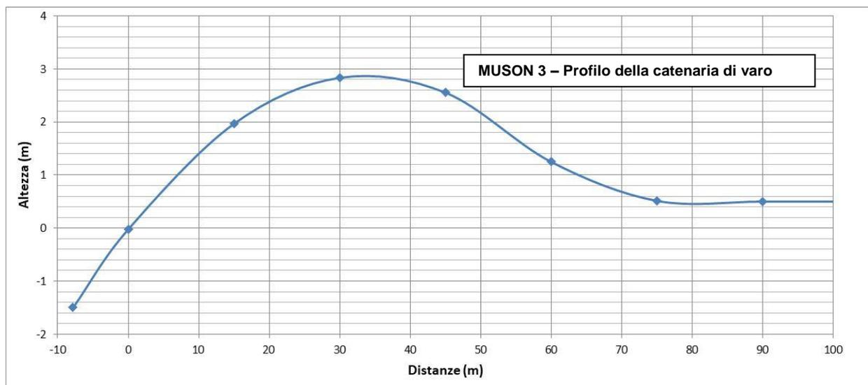
**Figura 6 – Grafico della curva di varo nell'ipotesi di angolo di uscita di  $12^\circ$  e raggio= 200 m**
