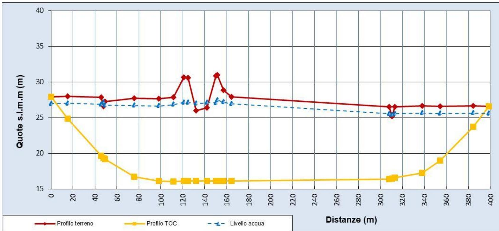
Figura 11 –Sezione schematica del terreno e della T.O.C. (entrata della trivellazione a sinistra)
