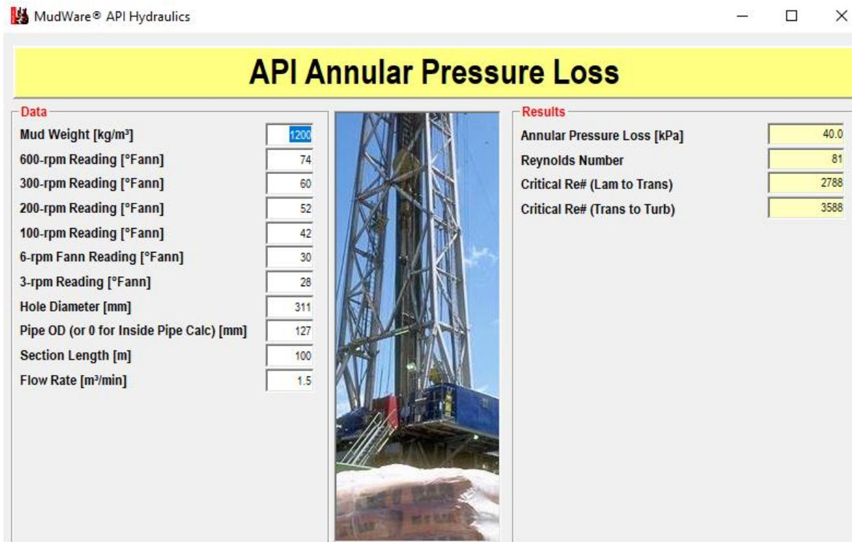
Figura 10 – Risultati del calcolo di caduta di pressione nell'anello per terreni sabbiosi e per terreni coesivi
