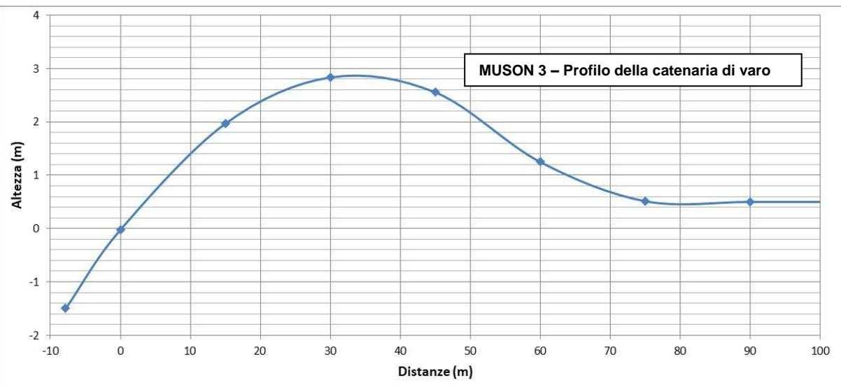
Figura 13 – Calcolo e grafico della curva di varo per angolo di uscita 12°, raggio 200 m. Altezza max. = 2.87 m
