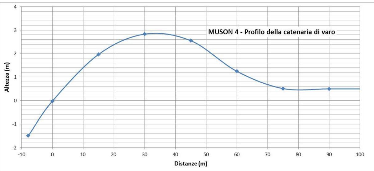
Figura 13 – Calcolo e grafico della curva di varo per angolo di uscita 12°, raggio 200 m. Altezza max. = 2.87 m
