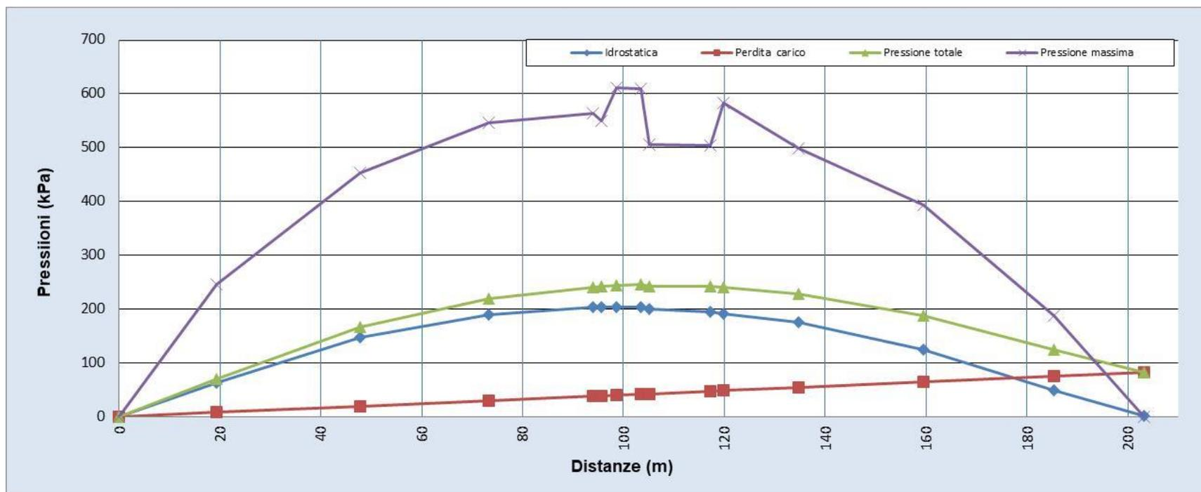
Figura 13- Andamento della pressione operativa e della resistenza del terreno in funzione della distanza dall'entrata
