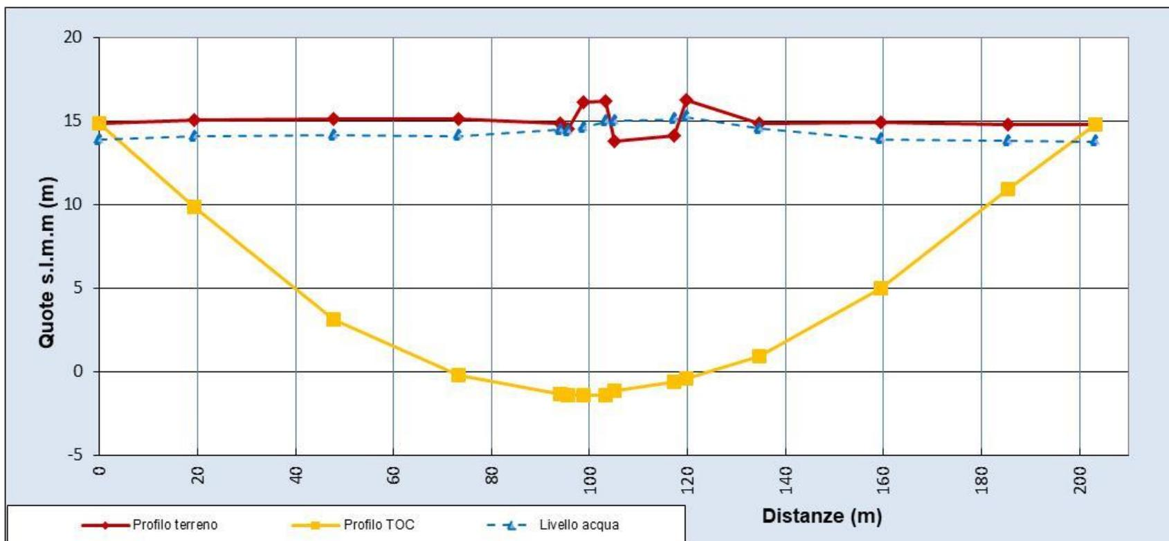
Figura 12 –Sezione schematica del terreno e della T.O.C. (entrata della trivellazione a sinistra)
