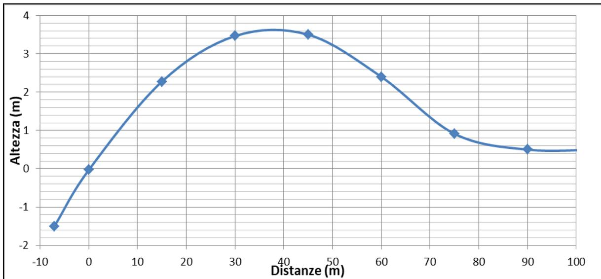
Figura 14 – Calcolo e grafico della curva di varo per angolo di uscita 13°, raggio 200 m. Altezza max. = 3.63 m
