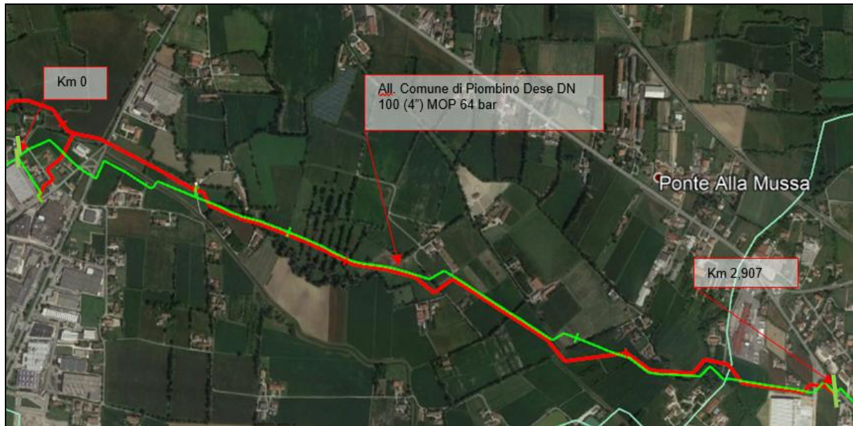
Figura 13 – All. Comune di Piombino Dese DN 100 (4") MOP 64 bar: stralcio foto satellitare (in rosso linea in progetto, in verde linea da dismettere)
