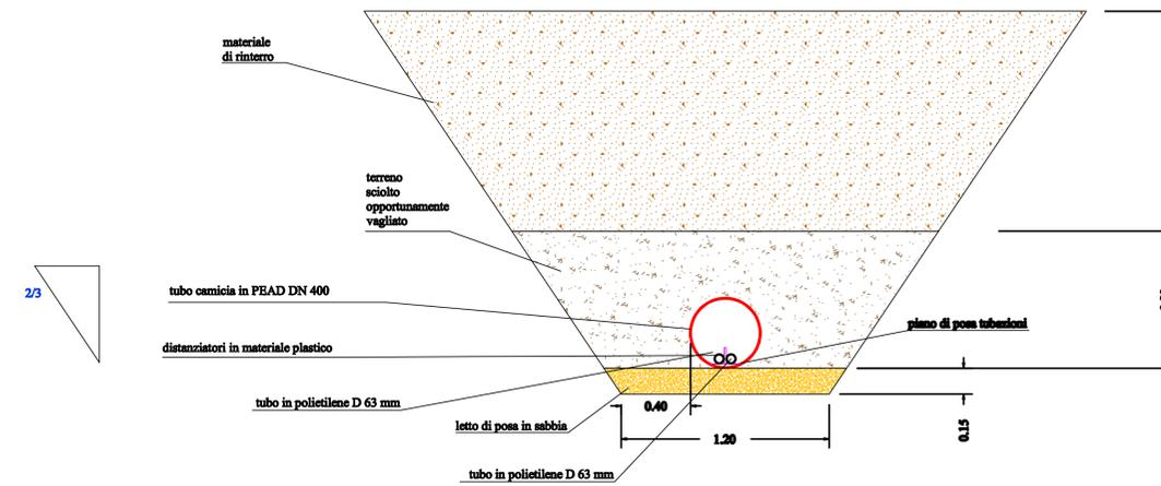
Sezione tipo di posa delle condotte in parallelismo - attraversamento stradale
