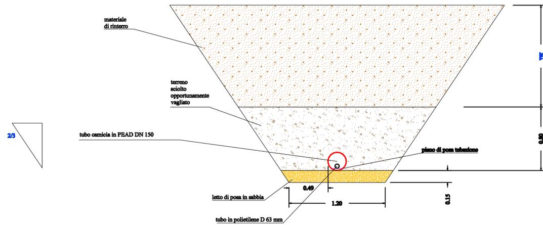
Sezione tipo di posa della condotta attraversamento SS 640
