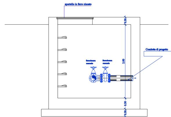
TIPOLOGICO POZZETTO - Attraversamento stradale
