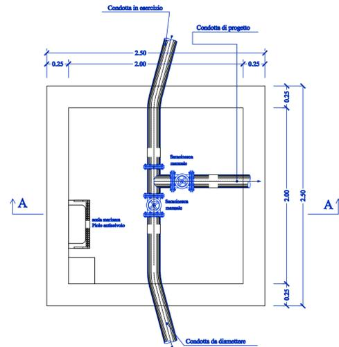
TIPOLOGICO POZZETTO - Attraversamento stradale
