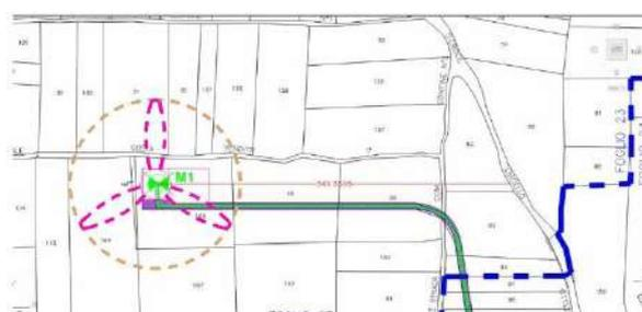
M01 = si nota, nel grafico rielaborato sulla destra, che l'aerogeneratore, con la proiezione dell'ingombro delle pale eoliche, **invade totalmente il tratto di Strada Comunale Costa Venditti**
