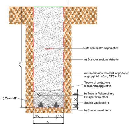
**TIPOLOGIA 4.1: Elettrodotto in banchina di Strada Provinciale in conglomerato bituminoso**
