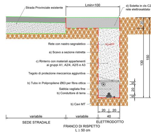
**TIPOLOGIA 4.2: Elettrodotto in banchina di Strada Provinciale in conglomerato bituminoso**
