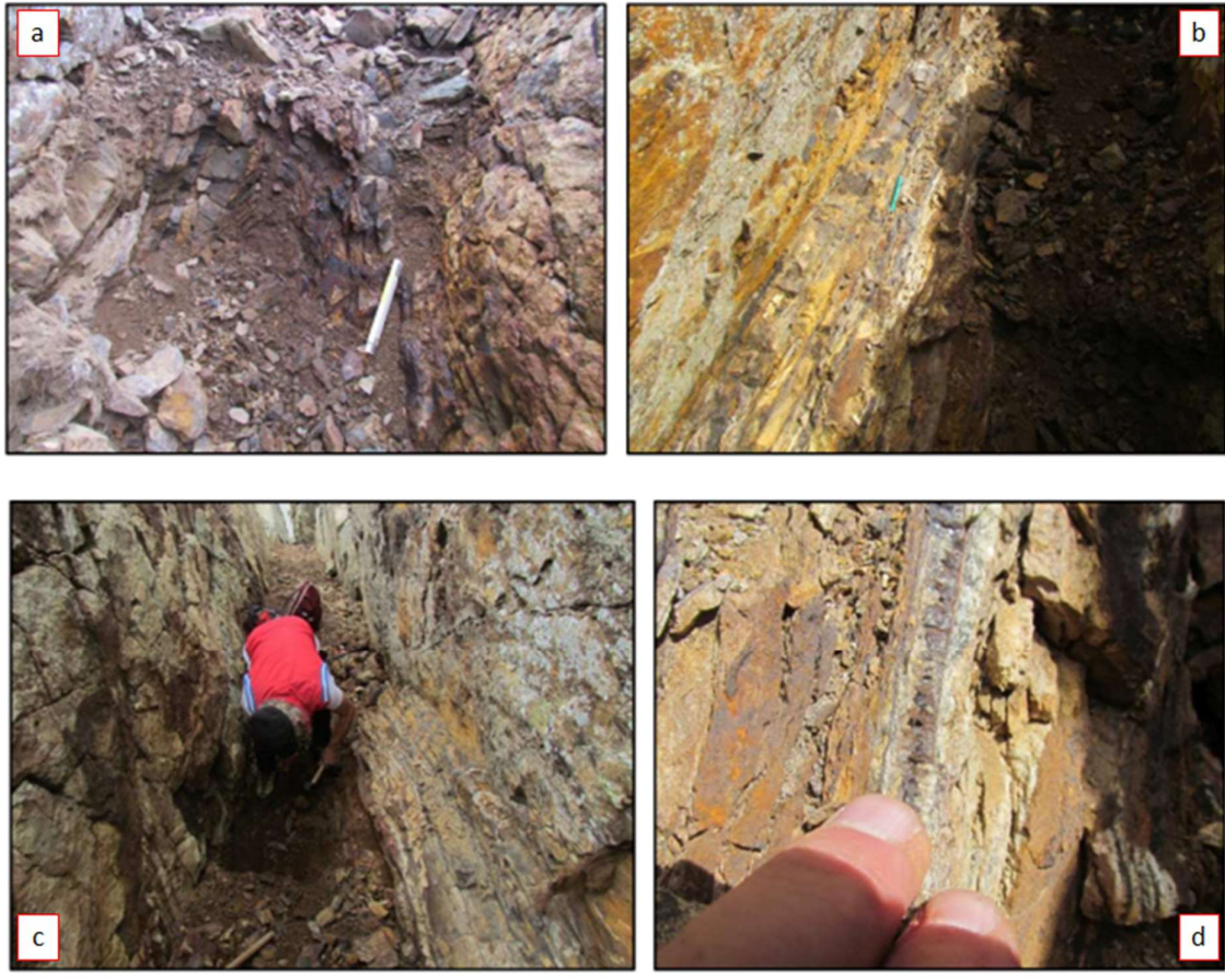
Figura 12. Dettagli delle vene mineralizzate: a: tessitura a bande quarzo-siderite in roccia incassante pervasivamente ossidata; b, c: altri dettagli di tessitura a bande quarzo-siderite; d: tessitura di tipo "comb" in nucleo di vena quarzifera di spessore centrimetrico.
