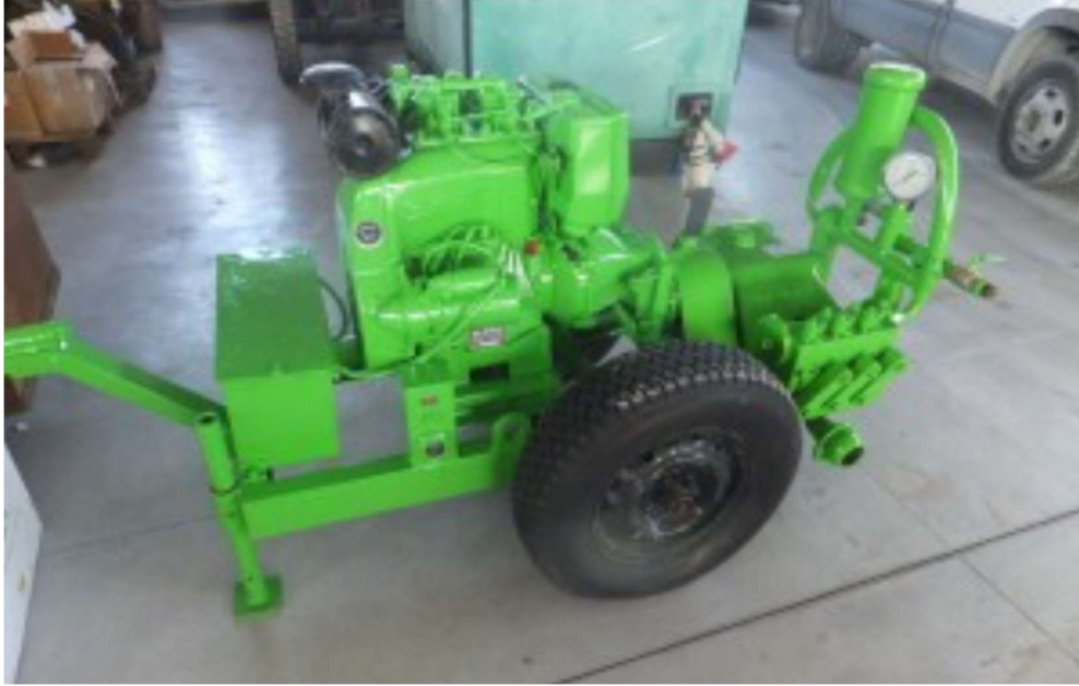
Figura 40. Pompa TRIPLEX TP90 impiegata per il trasporto di acqua dal campo base ai siti di perforazione.
