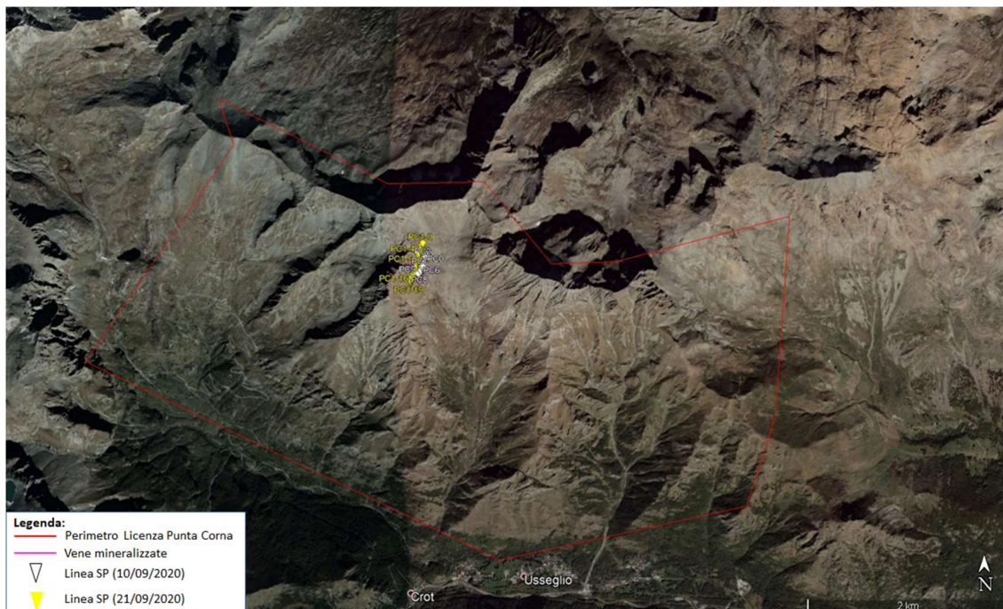
Figura 22. Immagine estratta da Google Earth con ubicazione della licenza Punta Corna e le linee geofisica intersecanti la vena San Giovanni e la vena Santa Maria (dettaglio immagine seguente).
