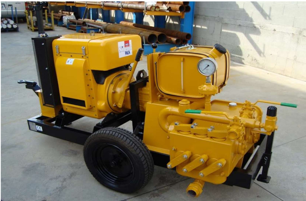
Figura 39. Pompa per il trasporto dell'acqua dal campo base ai siti di perforazione, modello TRIPLEX TP200.
