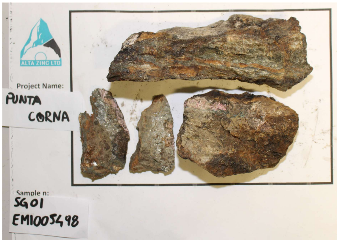
Figura 19. Esempio campione raccolto da Strategic Minerals (2020), della vena mineralizzata San Giovanni con presenza di skutterudite (minerale grigio-argenteo), eritrite (minerale rosa) e siderite (minerale marrone-bruno).
