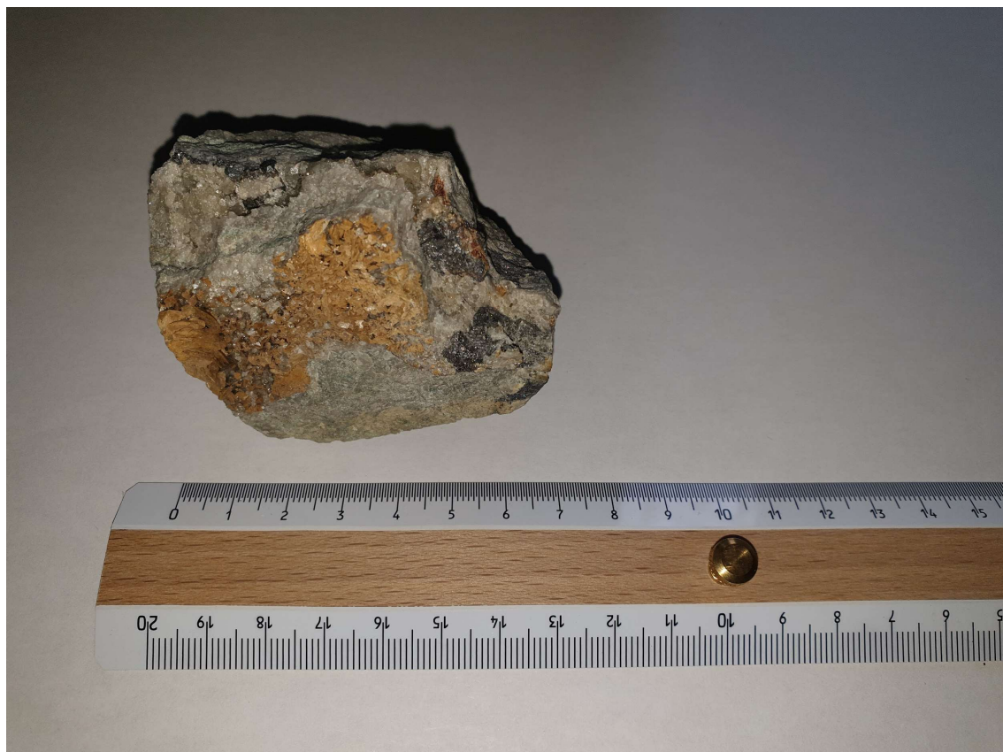
Figura 17. Esempio campione Nido dell'Aquila 2, raccolto dall'Università degli Studi di Milano (2018), con presenza di skutterudite (minerale grigio-argenteo) in matrice quarzo-carbonatica.
