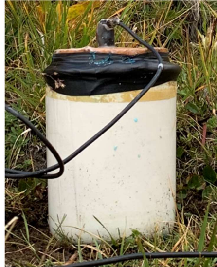
Figura 25. Struttura dell'elettrodo di misura (Telford,1990). Elettrodo in ceramica utilizzato per la misurazione del potenziale spontaneo.
