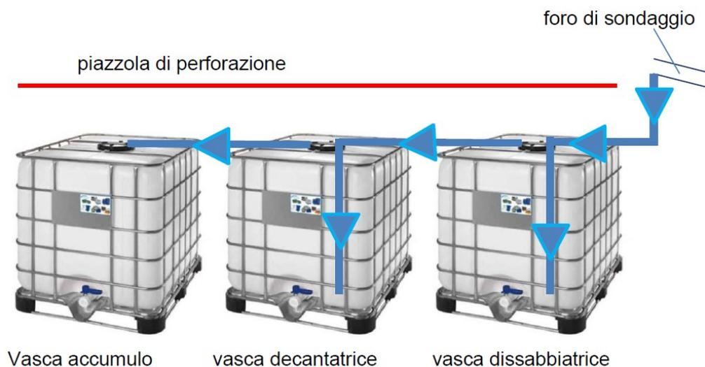
**Figura 1- Sistema di raccolta e riciclo acque**
