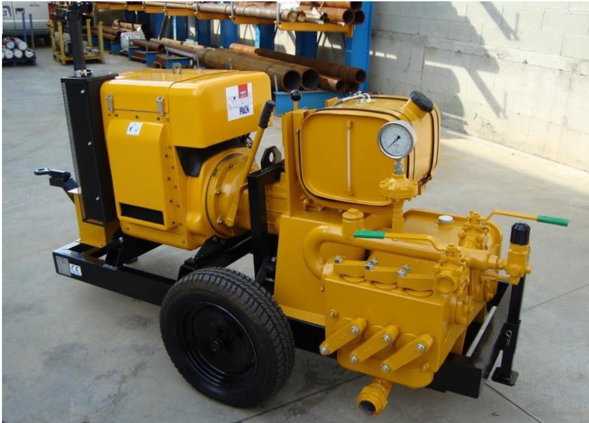
**Figura 3- Pompa di trasporto acqua dal campo base ai siti di perforazione**
