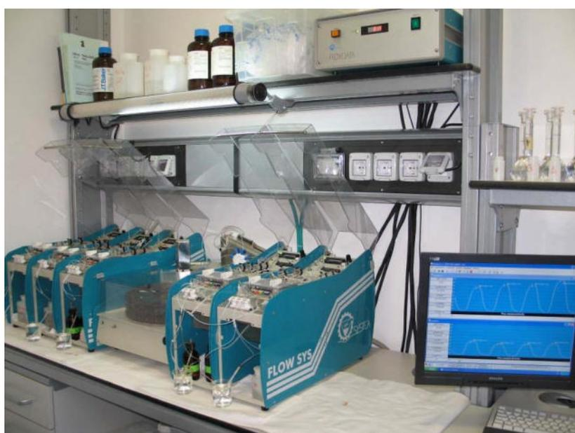
**Figura 1.1.2.1.** Analizzatore a flusso continuo *Flow-Sys Systema*.
