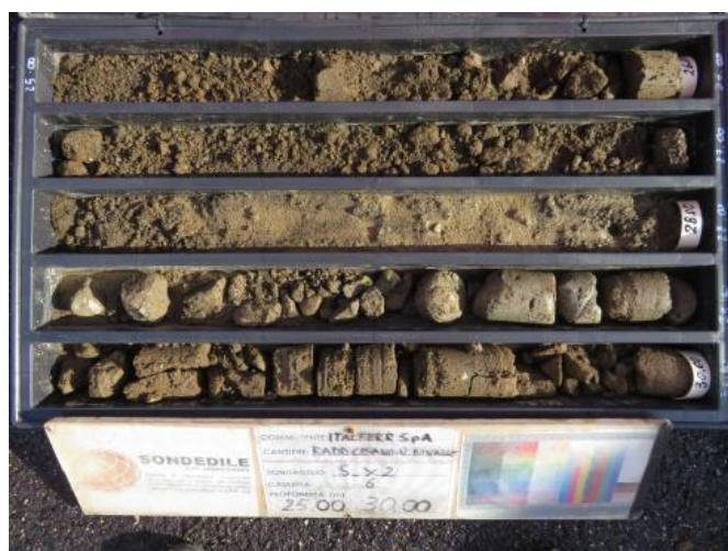
Figura 55 - Cassetta catalogatrice sondaggio SX2-2019 – U3c compatta
