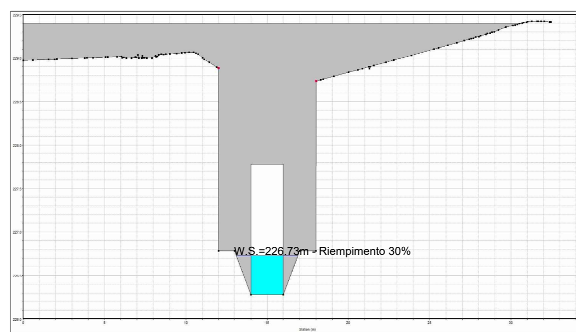
SEZIONE ATTRAVERSAMENTO POST OPERAM
