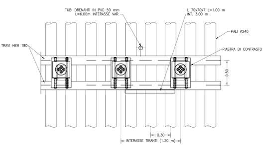
**TRAVE DI COLLEGAMENTO SEZIONE TRASVERSALE**
