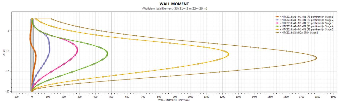
Figura 22 – Pali: Momento flettente massimo SLU/SLV
