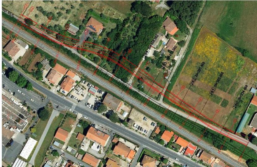
Il drenaggio consta in due fossi di guardia a lato della viabilità, i quali recapitano in parte attraverso una tubazione in PVC DN630 in una canaletta esistente, che verrà ripristinata. La restante porzione recapita nella rete esistente di fossi a lato della ferrovia.
