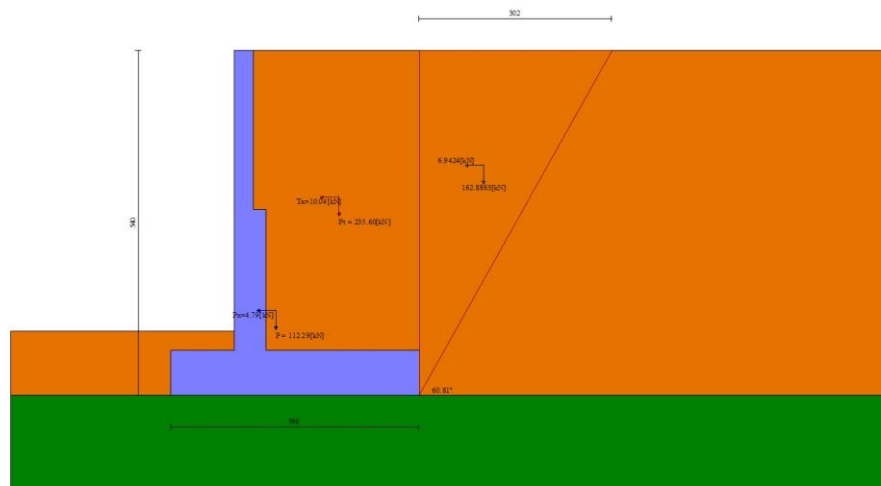
Fig. 5 - Cuneo di spinta (combinazione sismica) (Combinazione n° 2)
