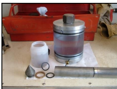
Figura3- Particolari della punta digitale e del setto poroso
