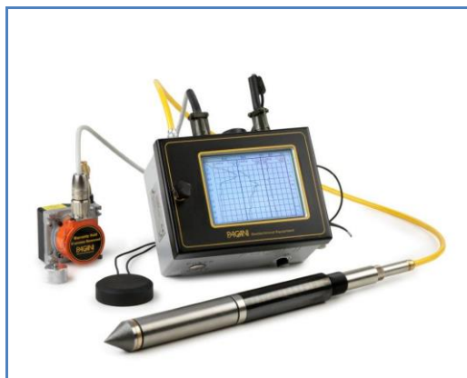
Figura 2 - Punta elettrica, piezocono, datalogger ed encoder
