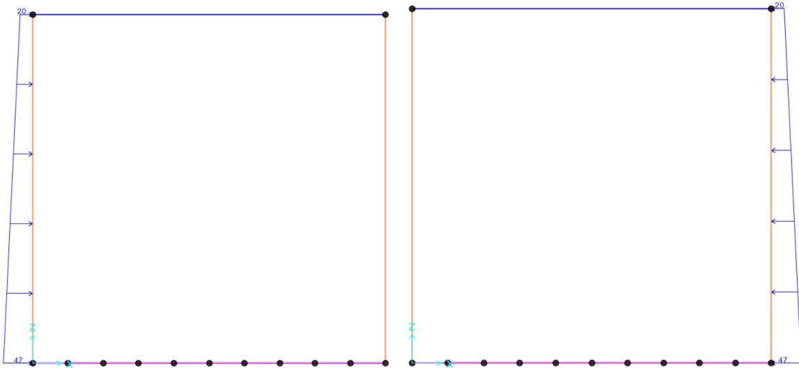
Figure 4: – Spinta del terreno – carico distribuito
