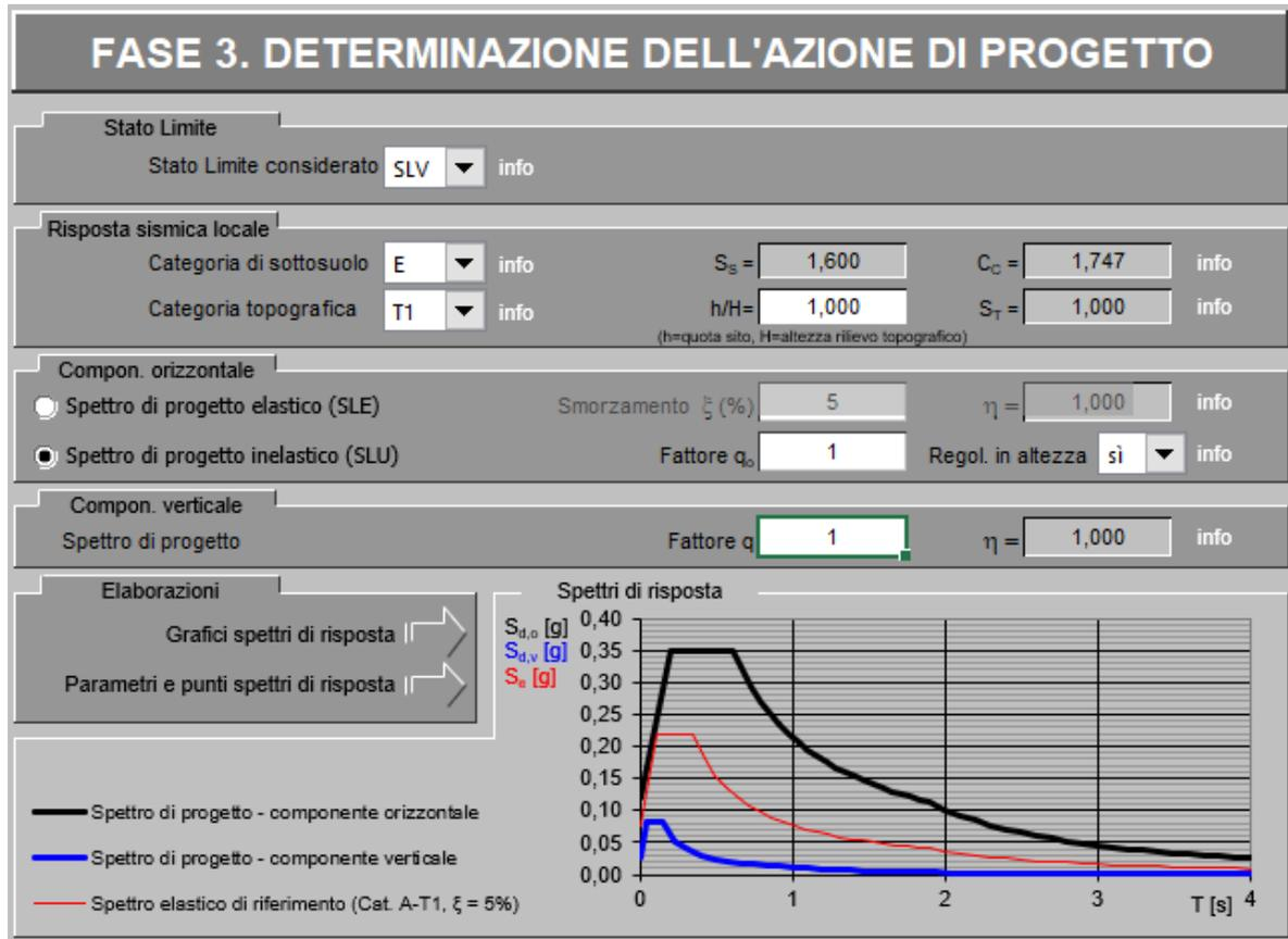
Figure 15:: Determinazione dell'azione di progetto
