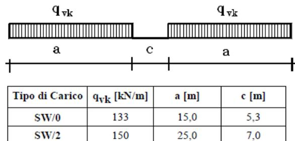
Figure 7: – Treno di carico SW
