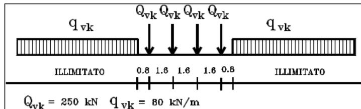
Figure 6: – Treno di carico LM71
