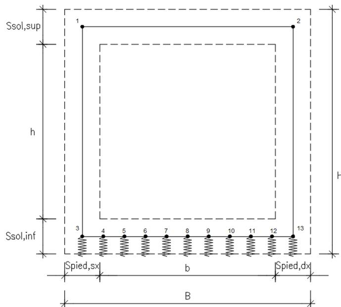
La fondazione è appoggiata su un insieme di molle elastiche che simulano la risposta del terreno di fondazione sottostante (molle alla Winkler calibrate sul modello geotecnico del terreno).
