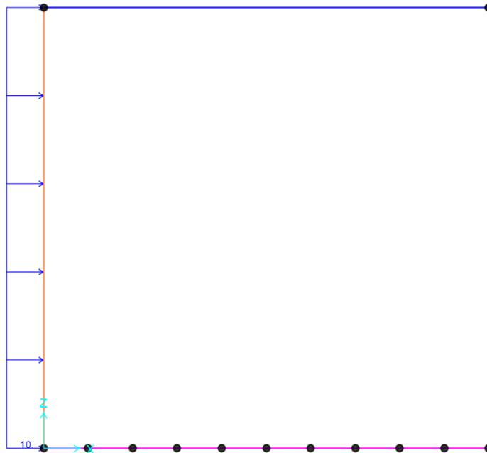
Figure 18:: sovraspinta sismica di wood
