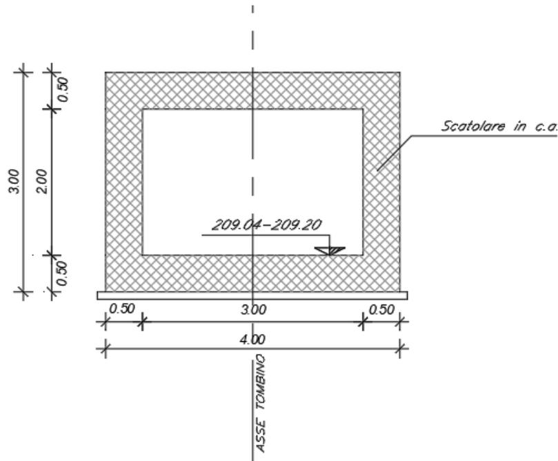
Figure 1: sezione trasversale del tombino
