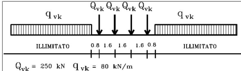
E' stato applicato un carico distribuito equivalente dei 4 assi 250 kN ad interasse 1.60 m.
