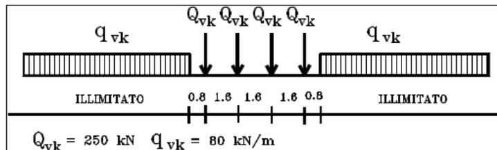
Figure 7: – Treno di carico LM71
