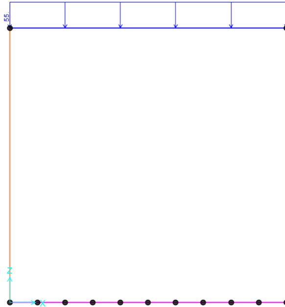
Figure 9: – Treno di carico sulla soletta
