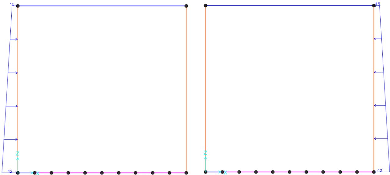
Figure 5: – Spinta del terreno – carico distribuito
