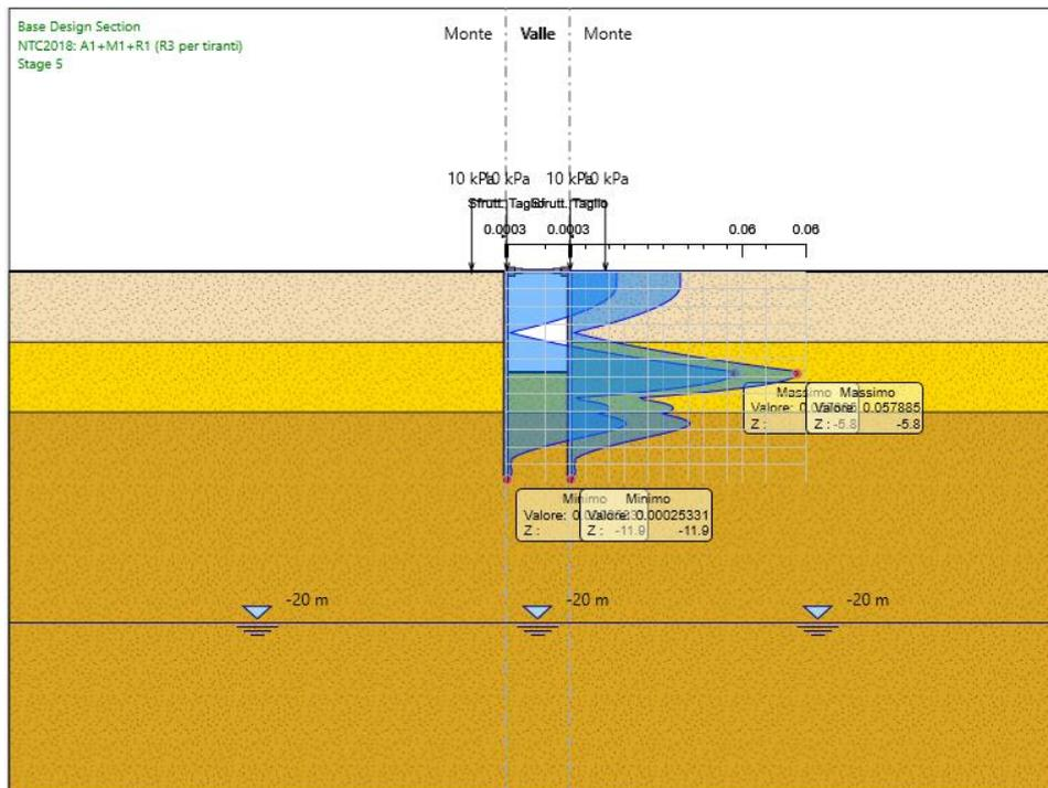
Figura 15 – Involuppo del massimo grado di sfruttamento del tubolare a taglio (SLU)
