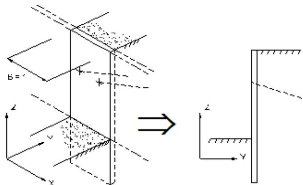
*Figura 3 – Schema di modellazione piana effettuata per mezzo del software PARATIE*
