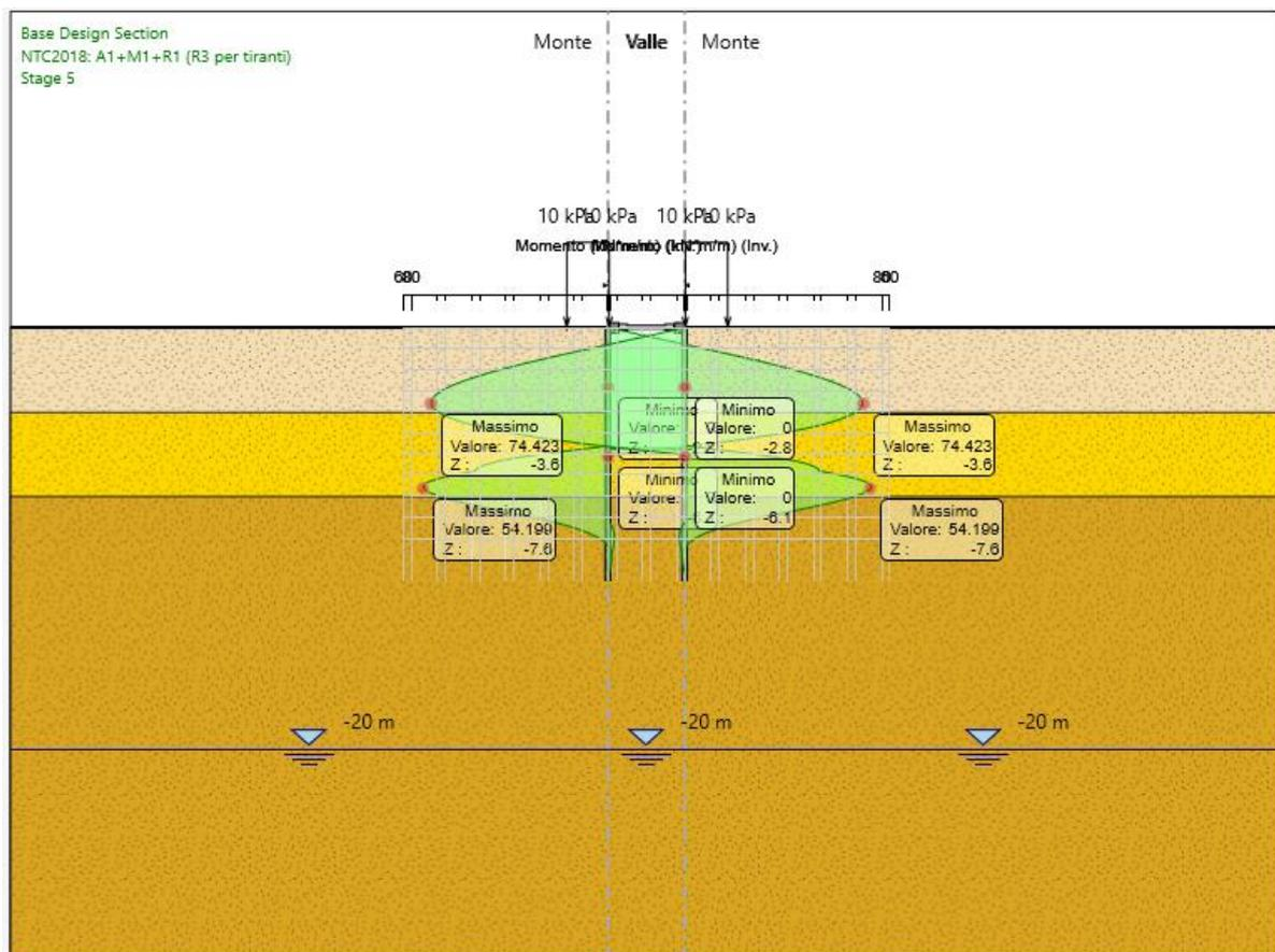
Figura 11 – Momento flettente massimo SLU ( $M_{max}=74 \text{ kNm/m}$ )
