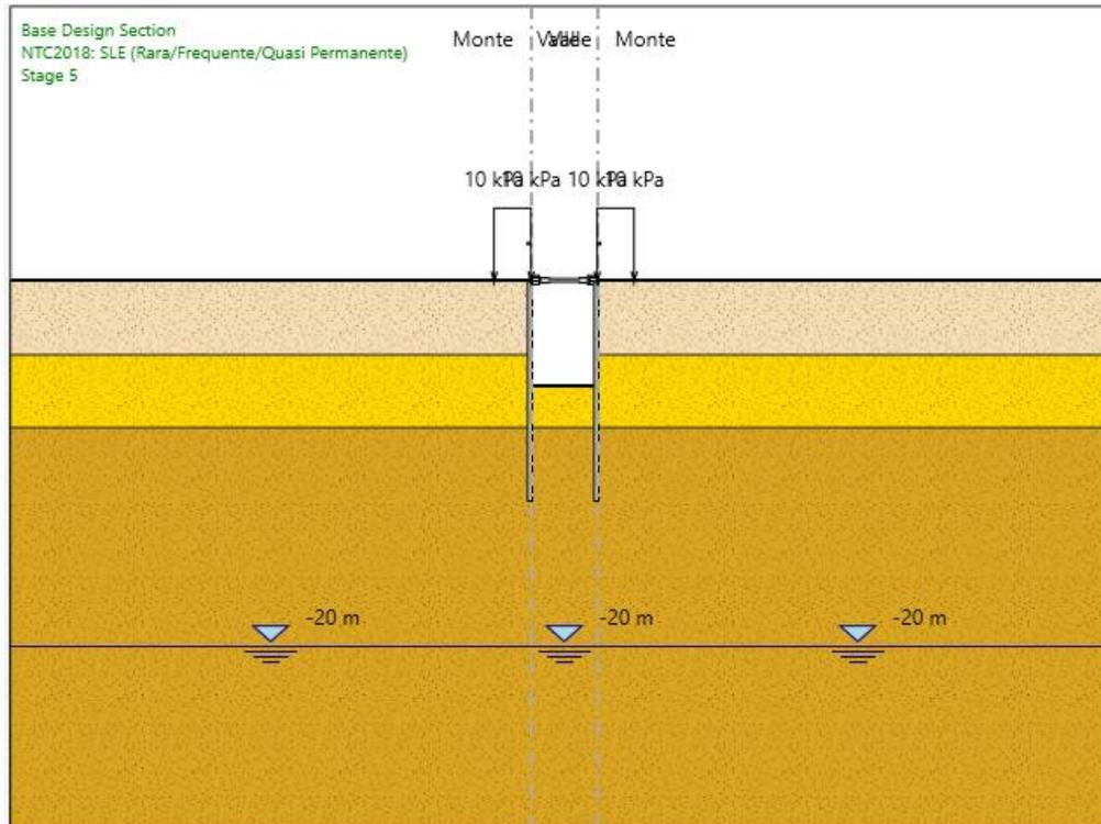
*Figura 5 – Modello di calcolo: massima profondità di scavo*
