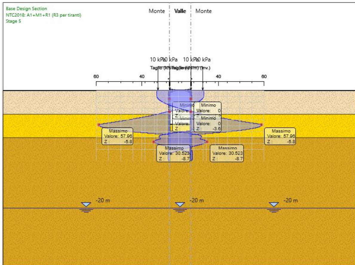
Figura 12 – Azione di taglio massima SLU ( $T_{max}=58 \text{ kN/m}$ )
