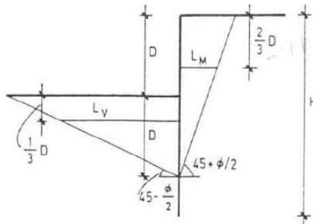
La realizzazione dello scavo sostenuto da una o due paratie, eventualmente tirantate, viene seguita in tutte le varie fasi attraverso un'analisi statica incrementale: ogni passo di carico coincide con una ben precisa configurazione caratterizzata da una certa quota di scavo, da un certo insieme di tiranti applicati, da una ben precisa disposizione di carichi applicati.
