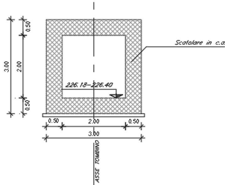
Figure 1: sezione trasversale del tombino
