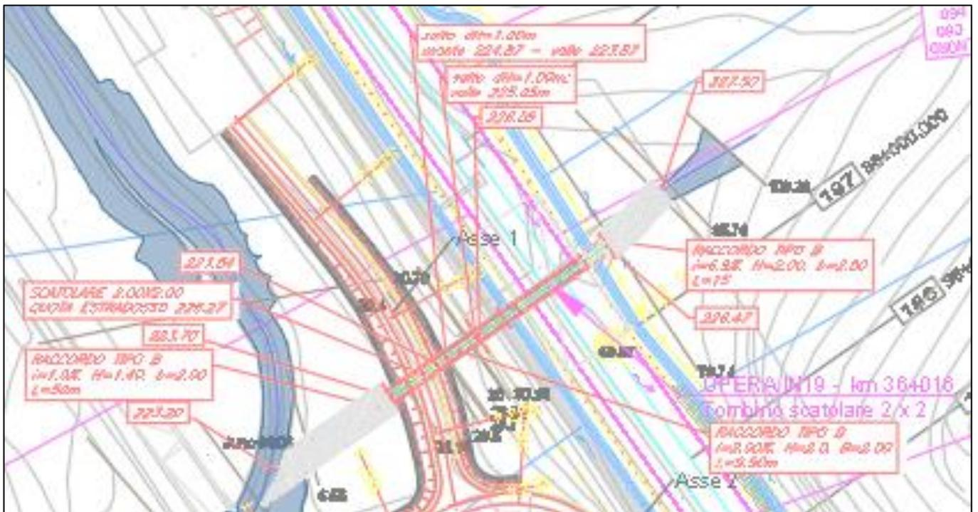
Figure 5: sistemazione idraulica di raccordo
