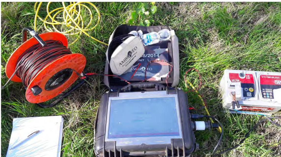
Figura 2: Sismografo digitale a 24 bit.
