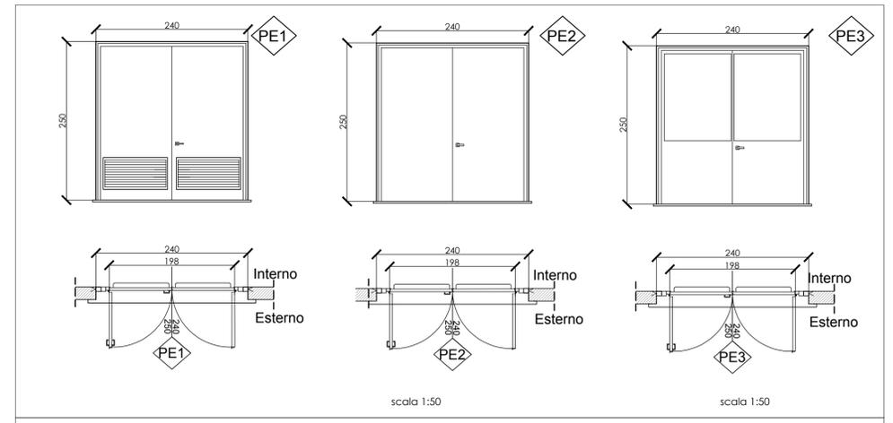
Tipologia SERRAMENTO A DOPPIA ANTA IN ALLUMINIO PREVERNICIATO A TAGLIO TERMICO - Dim. 240x250 cm CON MANIGLIONE ANTIPANICO
