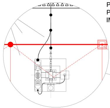
**PARTICOLARE COLLEGAMENTO PALO SEZIONATORE CON IMPIANTO DI TERRA**
