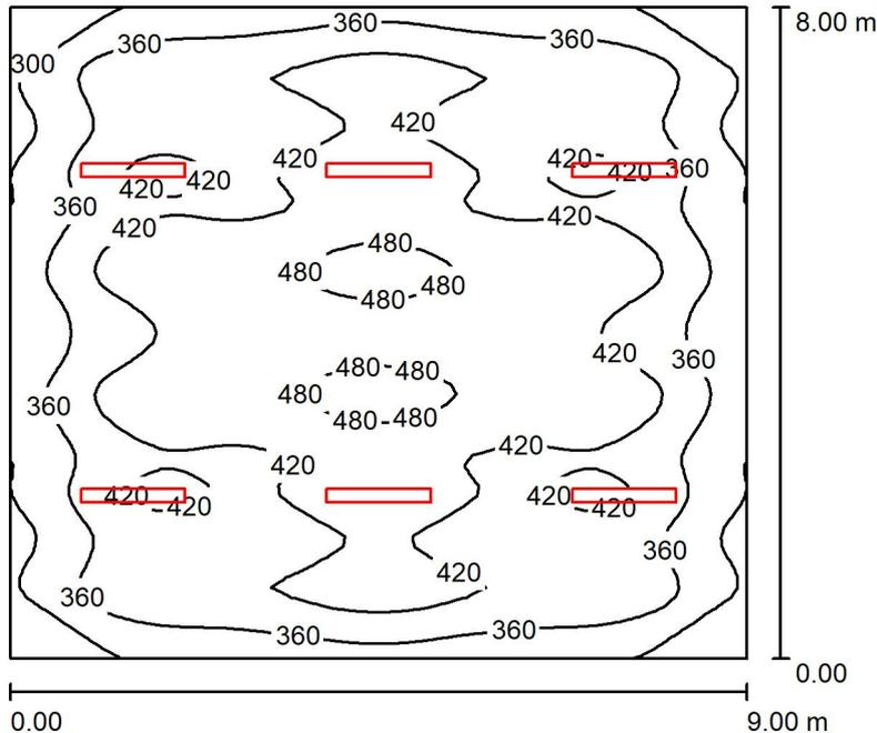
Altezza locale: 3.400 m, Altezza di montaggio: 3.400 m, Fattore di manutenzione: 0.80
