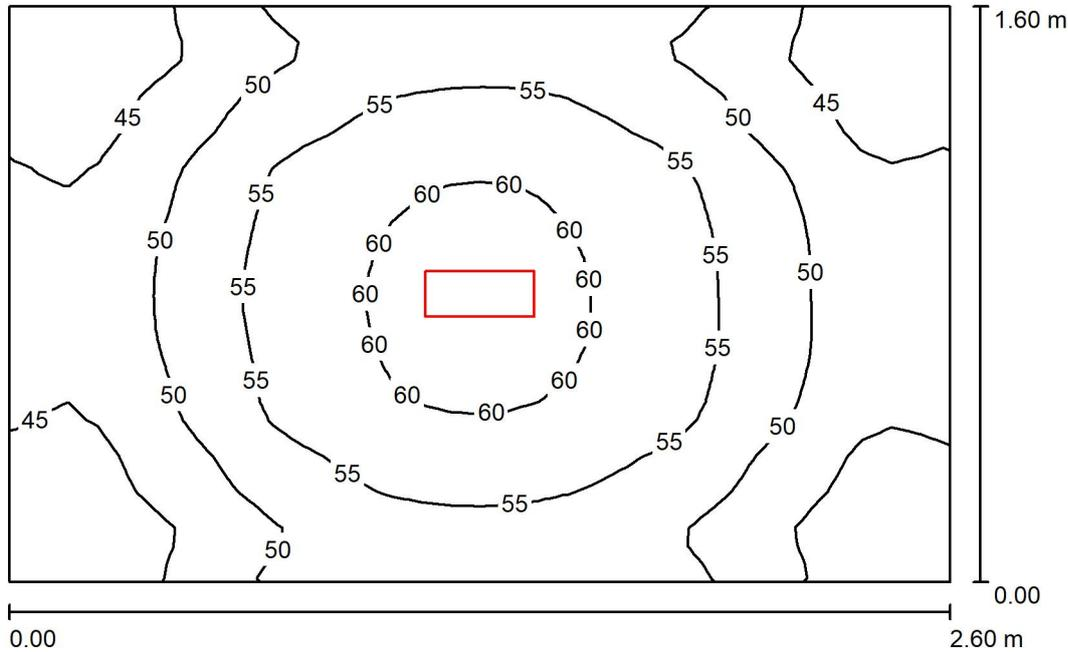
Altezza locale: 3.400 m, Altezza di montaggio: 3.400 m, Fattore di manutenzione: 0.80
