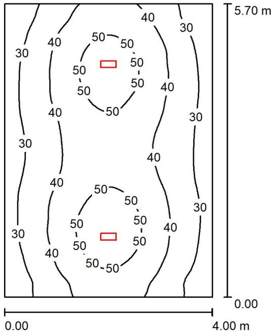
Altezza locale: 3.400 m, Altezza di montaggio: 3.400 m, Fattore di manutenzione: 0.80
