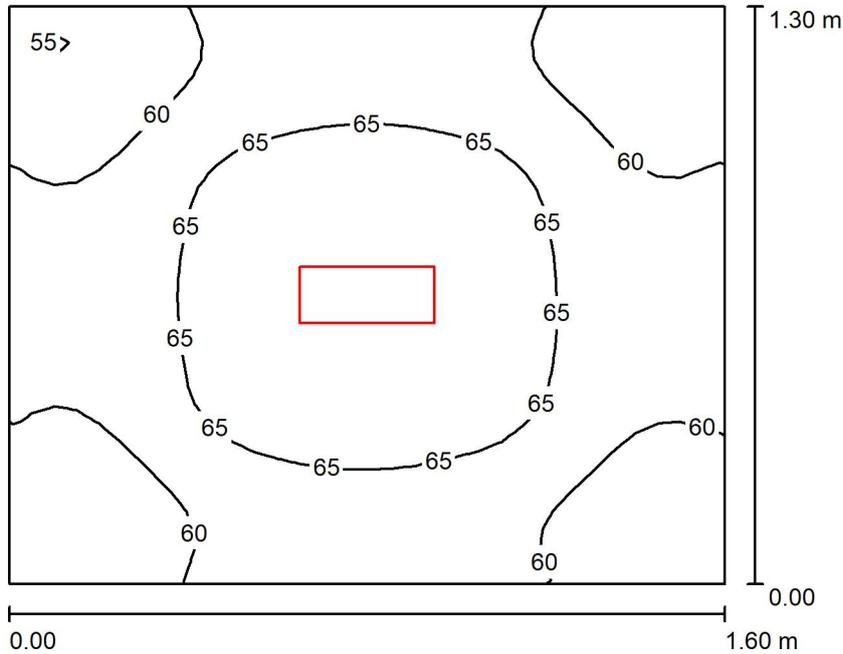
Altezza locale: 3.400 m, Altezza di montaggio: 3.400 m, Fattore di manutenzione: 0.80
