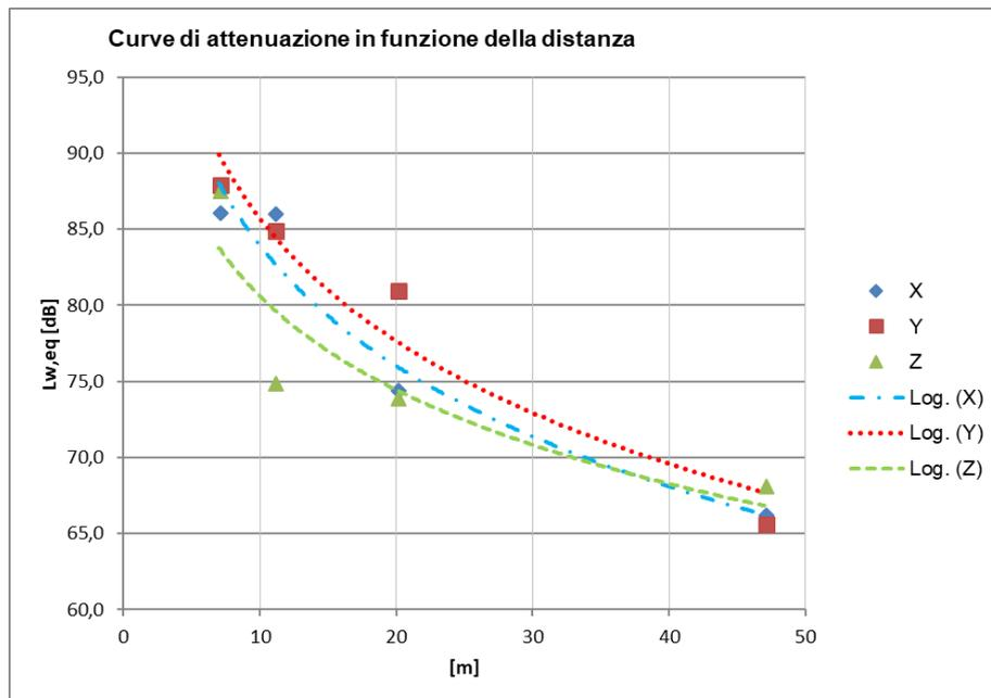
Figura 3 - Curva di attenuazione del  $L_{w,eq}$  in funzione della distanza dal binario, ricavata dai rilievi sperimentali sull'attuale linea in esercizio lungo gli assi x,y e z, in corrispondenza delle VIB 01,02, 03 e 04
