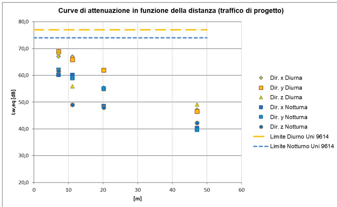
Figura 4 – Curve di attenuazione in funzione della distanza relativa al traffico ferroviario di progetto
